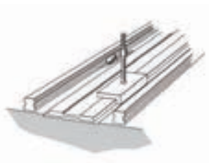
圖 1.11.14 用直線塊規的方法
