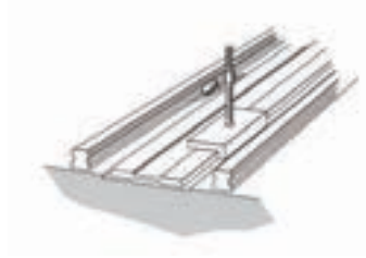
圖 1.11.14 用直線塊規的方法
