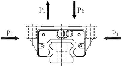
圖 1.6.3 滑軌的負荷方向、力矩方向
