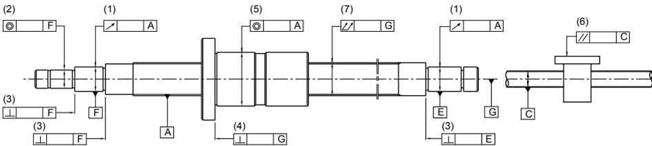
圖 1.3.2 滾珠螺桿安裝部位的精度 (ISO 3408)
