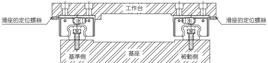
圖 1.11.12 基準側滑軌沒有定位螺絲的情況
