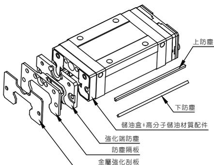
DZ (強化雙端防塵 + 下防塵 + 上防塵 + 高分子儲油材質配件 + 金屬強化刮板)
