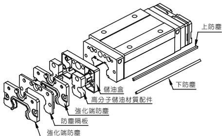
DU (強化端防塵 + 下防塵 + 上防塵 + 高分子儲油材質配件 + 金屬強化刮板)
