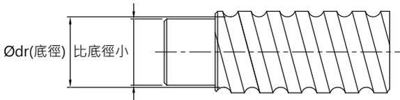
圖 1.10.4 出牙—內循環軸端必要條件
