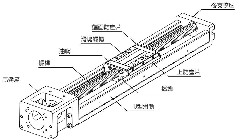
圖 1.1.1 單軸機器人本體結構
