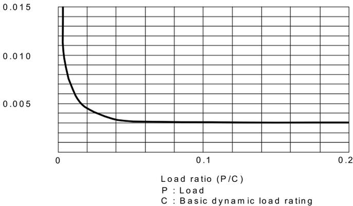
線性滑軌透過滾珠或滾柱等滾動體進行負荷移動，摩擦是傳統滑動移動的摩擦的 1/40，而造成摩擦力的原因可有潤滑品的黏稠阻力、預壓力摩擦阻力、作用力產生的摩擦力，上圖是線軌受作用力時摩擦係數的表現。
