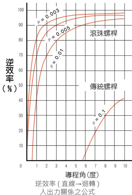
$\mu$  : 摩擦係數 (研磨螺桿  $\mu=0.005$  轉造螺桿  $\mu=0.01$ )
