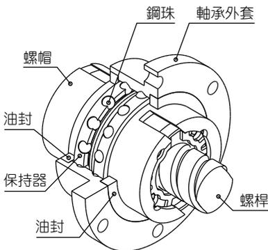
圖 1.1.4 RFSY 型本體結構
